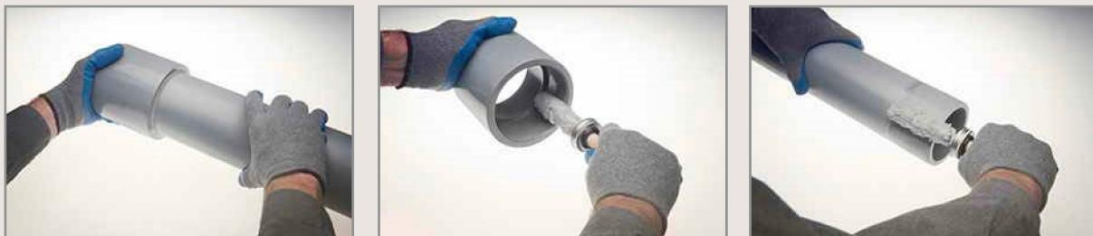
سیستم اتصال ترجیحی برای بیشتر نصب‌های PVC چسب حلالی است. سهولت اتصال، دوام و یکارچگی محل اتصال و هزینه پایین این روش اتصال، PVC را به یکی از محبوب‌ترین و برترین سیستم‌های لوله‌گذاری در جهان مبدل کرده است.
